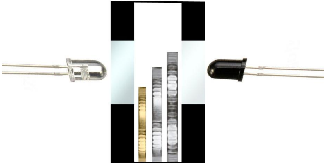
Рисунок 2.2 – Схема оптичного визначення номіналу монети
