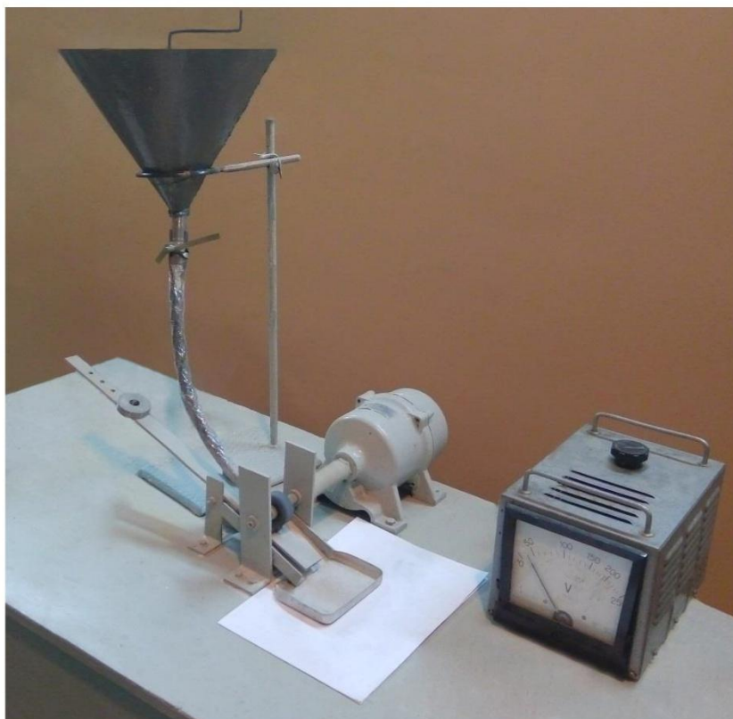
Рисунок 2.3 – Загальний вигляд установки для випробування за умов абразивного зношування
