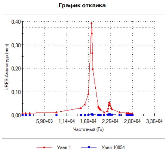
Рисунок 5.2.5 – Амплітуда переміщень в вузлах деталі 1 і 10854
