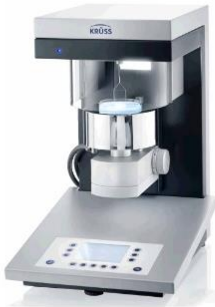
Рисунок 1.9 – Автоматичний тензіометр K20 для визначення міжфазного натягу
