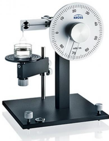
Рисунок 1.8 – Тензіометр К6 заснований на методі відриву кільця (метод Дю Нуї)
