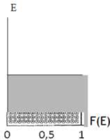
Рис.2.6.—Зв'язок енергії електронів з ймовірністю їхнього заповнення на конкретному енергетичному рівні при температурі абсолютного нуля (для металів).
