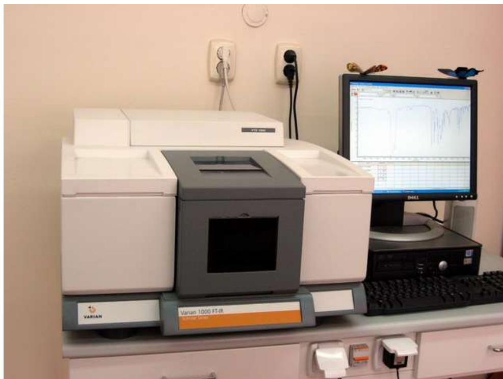
Рисунок 1.2 – Інфрачервоний спектрометр — прилад для реєстрування інфрачервоних спектрів поглинання, пропускання чи відбиття речовин.
