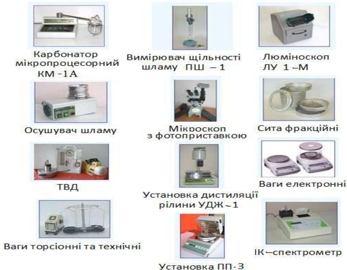
Рисунок 1.8 – Обладнання та прилади геологічного модуля станції
