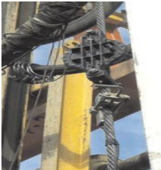
Рисунок 2.10 – Приклад давачів натягу талевого каната, встановлених на «мертвому кінці»
