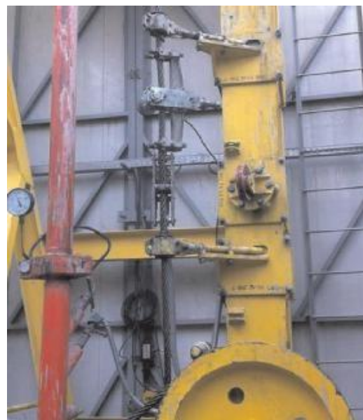
Рисунок 2.10 – Приклад давачів натягу талевого каната, встановлених на «мертвому кінці»
