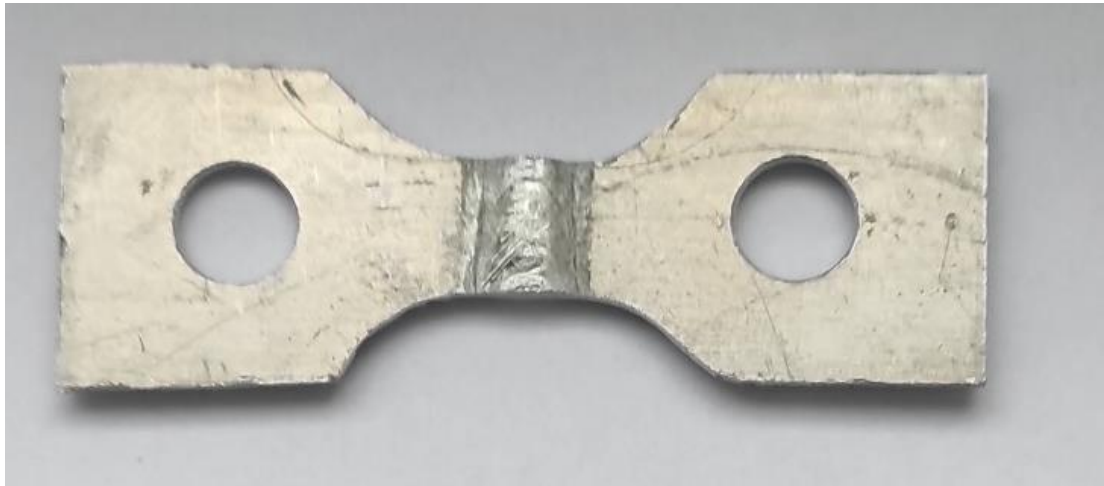
Рисунок 2.7 – Загальний вигляд зразка для випробувань на розтяг зварних з'єднань
