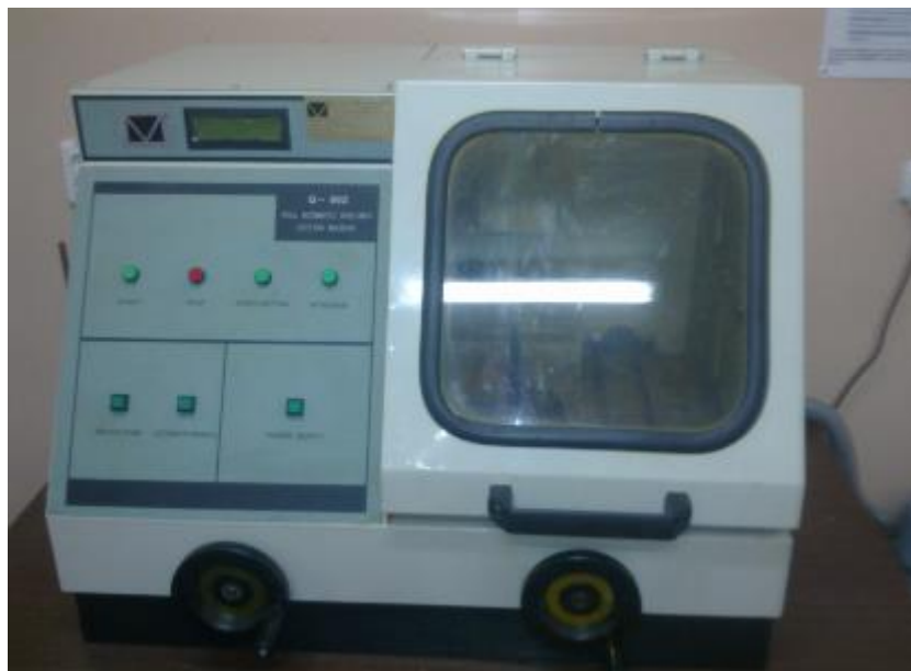
Рисунок 2.2 – Верстат Q-80Z з водяним охолодженням для вирізання зразків з трубного сегмента
