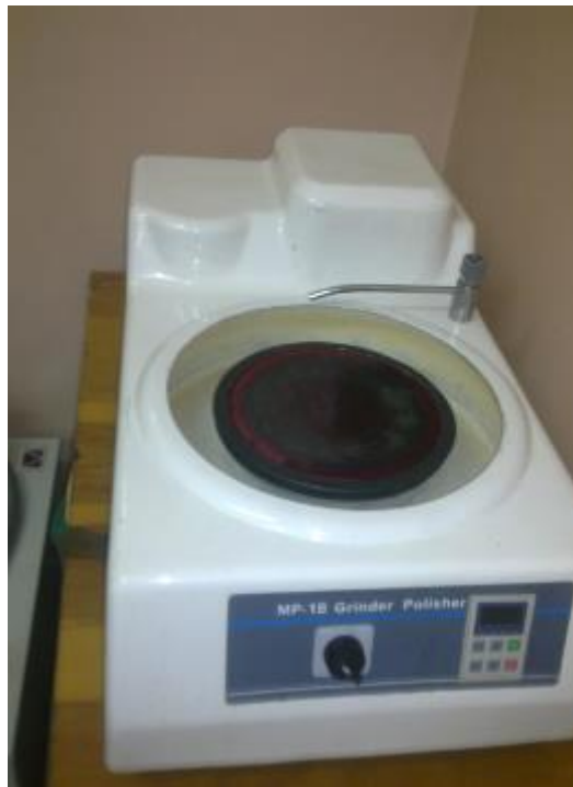
Рисунок 2.3 – Верстат МР-1В для шліфування та полірування металографічних зрізків
