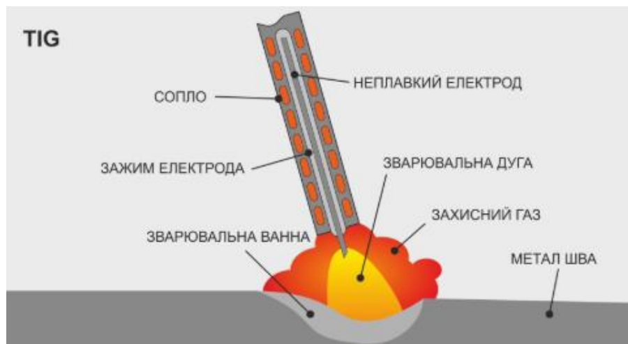
Рисунок 1.15 – Схема виконання зварювання неплавким електродом у захисних газах
