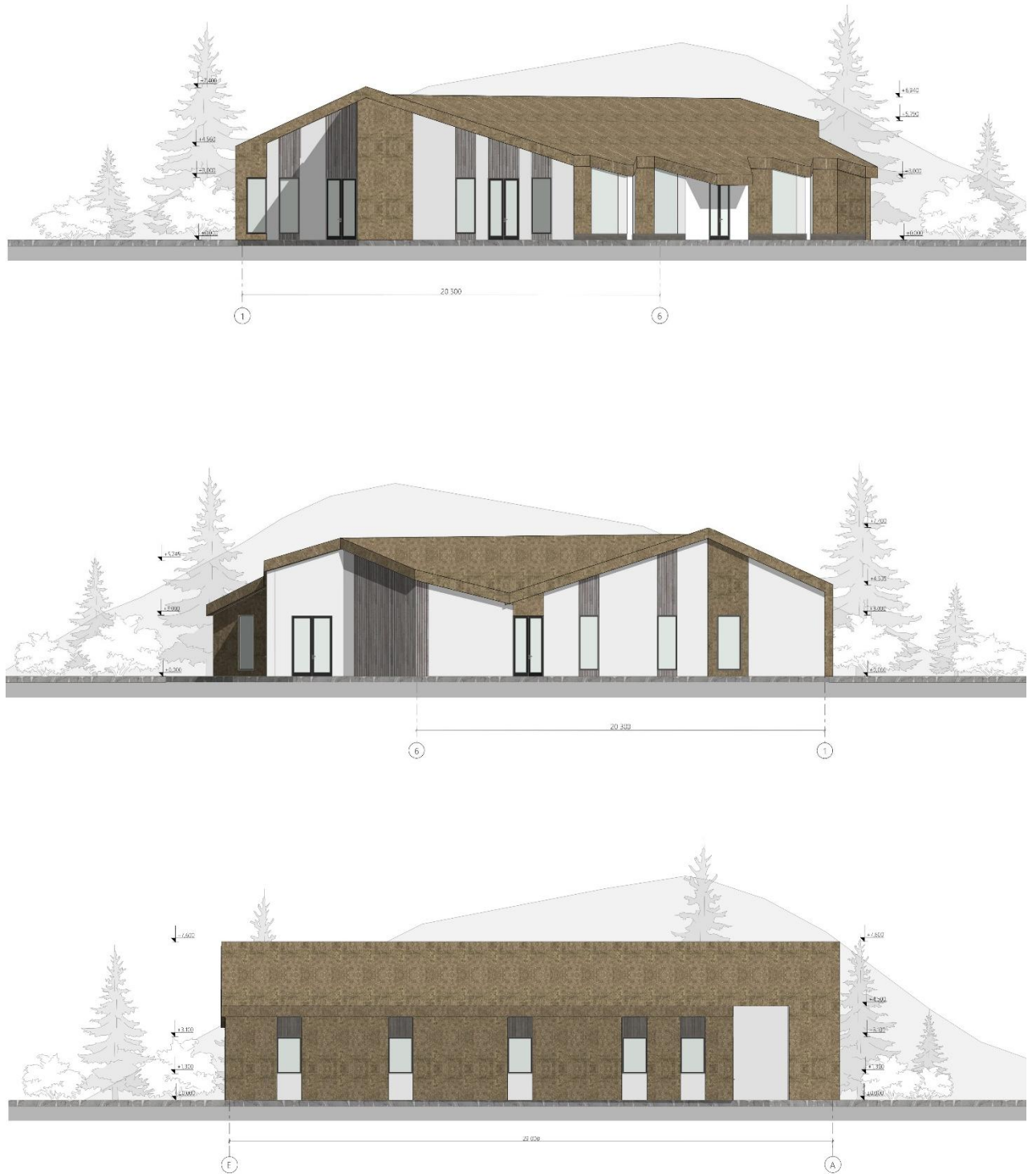
Рис.3.26. Фасади харчового корпусу
