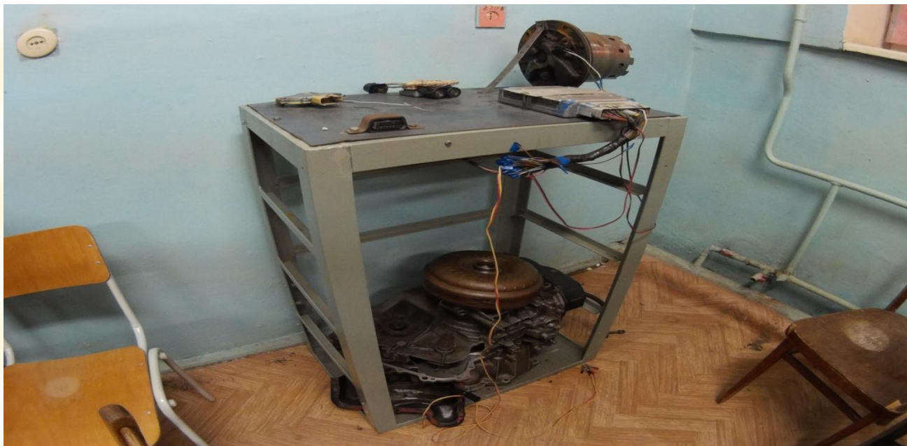
Рисунок 9.1 – Експериментальна установка для діагностики АКПП SF31J з електронним управлінням
