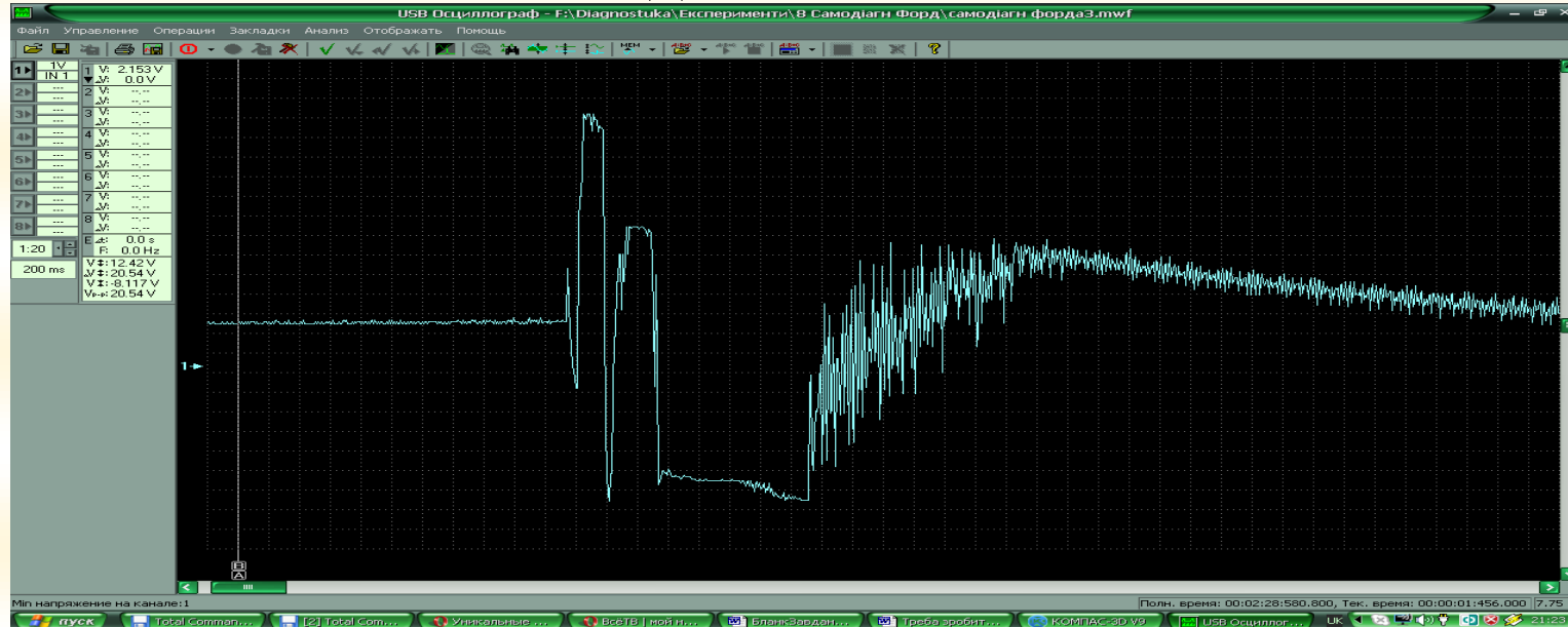
Рисунок 10.1 - Осцилограма запуску сеансу обміну даними з блоком управління АКПП SF31J
