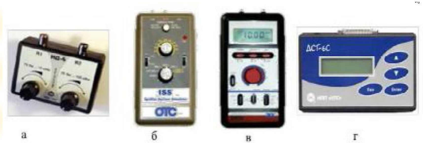
Рис. 5.1. Імітатори сигналів давачів АКПП: а - резистивних; б, в - аналогових та імпульсних; г - у складі комбінованого приладу
