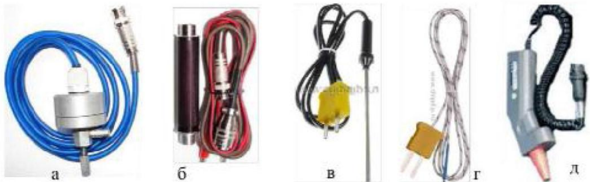
Рис. 2.3. Зовнішній вигляд вимірювальних зондів неелектричних величин: а, б - тиску рідини та газів; в - температури рідини та газів; г - температури твердої поверхні; д - інфрачервоного випромінювання
