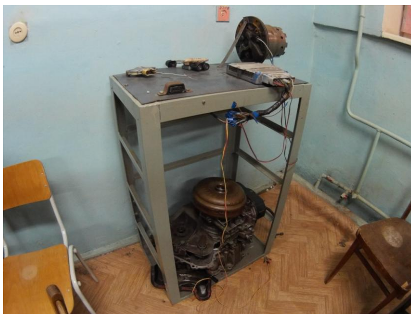
Рисунок 4.1 – Експериментальна установка для діагностики автоматичної коробки передач SF31J з електронним управлінням
