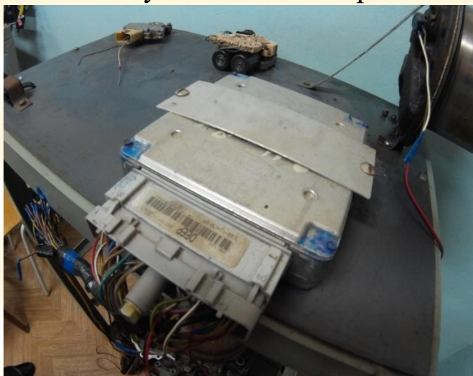
Рисунок 9.2 – Блок управління АКПП SF31J
