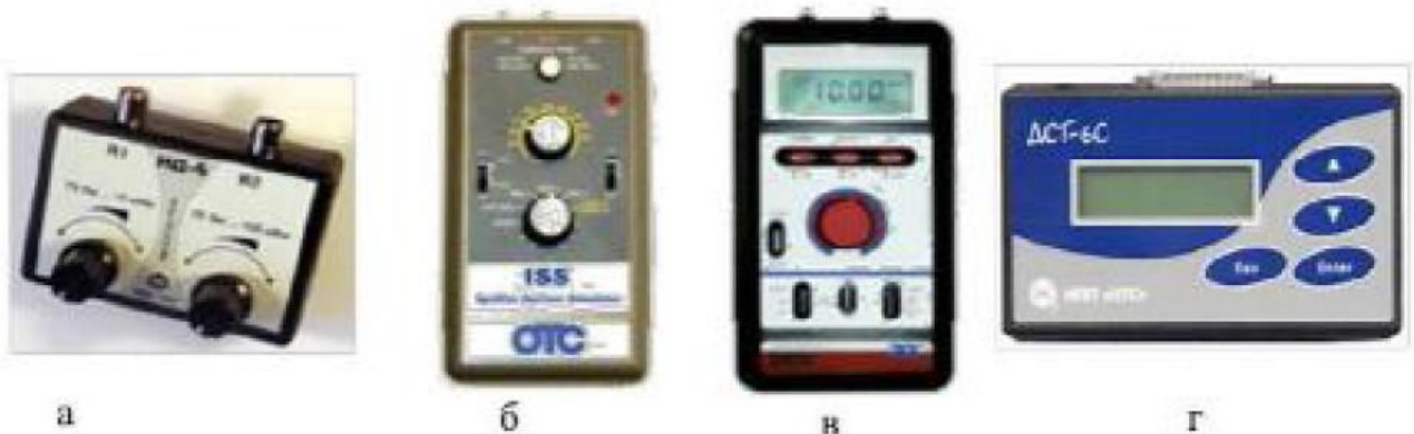
Рис. 2.1. Зовнішній вигляд імітаторів сигналів датчиків: а - резистивних; б, в - аналогових та імпульсних; г - у складі комбінованого приладу
