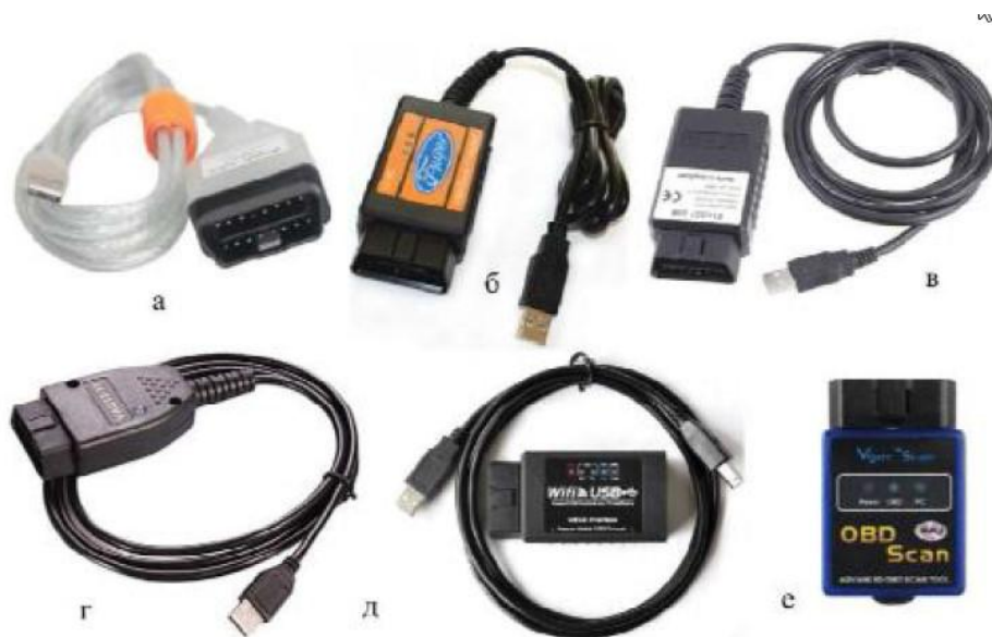
Рис. 2.7. Діагностичні адаптери для програмних сканерів: а, б, в, г – провідного типу; д, е - капсульного типу
