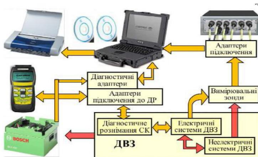
Рис. 3.2. Схема та принцип роботи модульних мотор-тестерів
