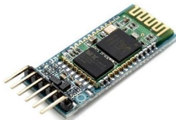
Рисунок 2.14 – Bluetooth модуль HC-05
