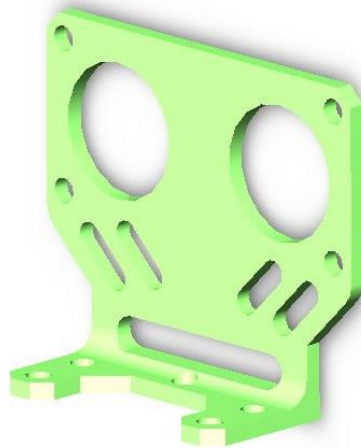
Рисунок 4.11 - Модель тримача датчик відстані HC-SR04
