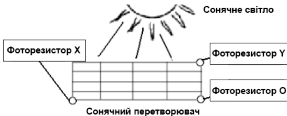
Рисунок 1.9 – Розташування фоторезисторів Х, О та Y на ФЕМ [3]
