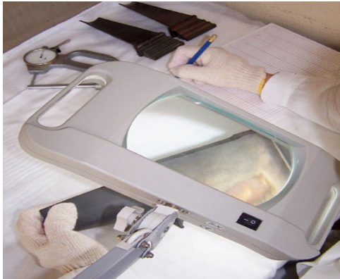
Рисунок 1.15 – Проведення візуально-вимірювального контролю лопаток
