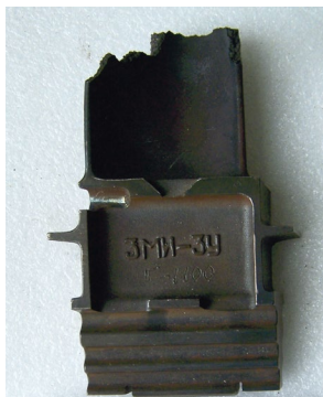
Рисунок 1.14 – Руйнування робочої лопатки турбіни внаслідок теплового удару
