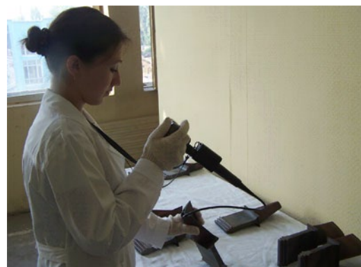
Рисунок 1.18 – Використання ендоскопа для діагностування внутрішніх дефектів
