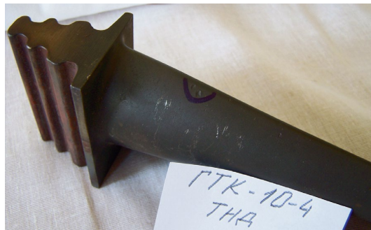
Рисунок 1.11 – Механічне пошкодження лопатки турбіни
