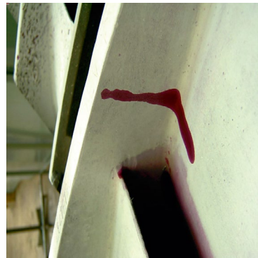
Рисунок 1.9 – Розтріскування елементів соплового апарату
