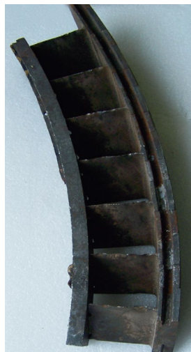
Рисунок 1.10 – Деформація поверхні сегмента соплового апарату
