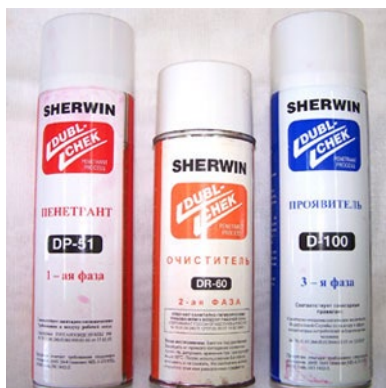
Рисунок 1.20 – Комплект засобів для капілярного контролю
