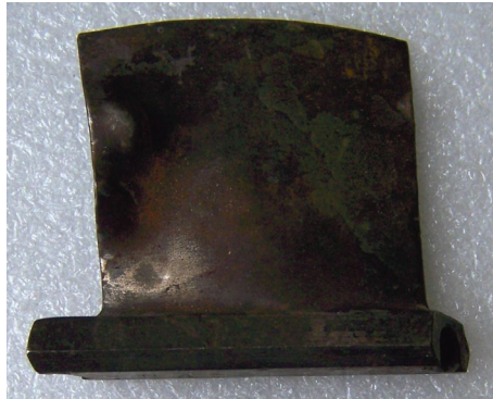
Рисунок 1.3 – Пошкодження лопатки компресора із розвитком тріщини
