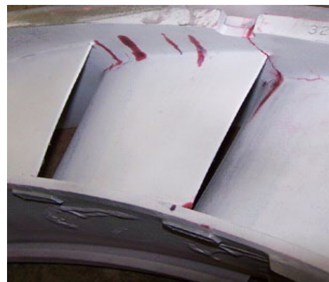
Рисунок 1.21 – Виявлення дефектів методом капілярної дефектоскопії
