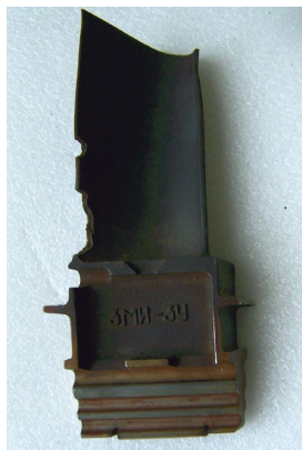
Рисунок 1.13 – Ознаки термічного перевантаження лопатки турбіни
