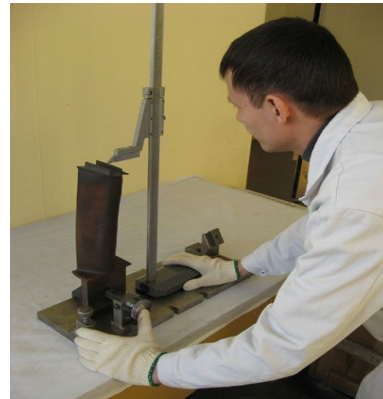
Рисунок 1.16 – Вимірювання геометричних параметрів лопаток
