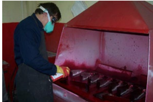
Рисунок 1.19 – Проведення капілярного контролю лопаток
