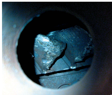
Рисунок 1.4 – Руйнування лопаток компресора внаслідок роботи в помпажному режимі
