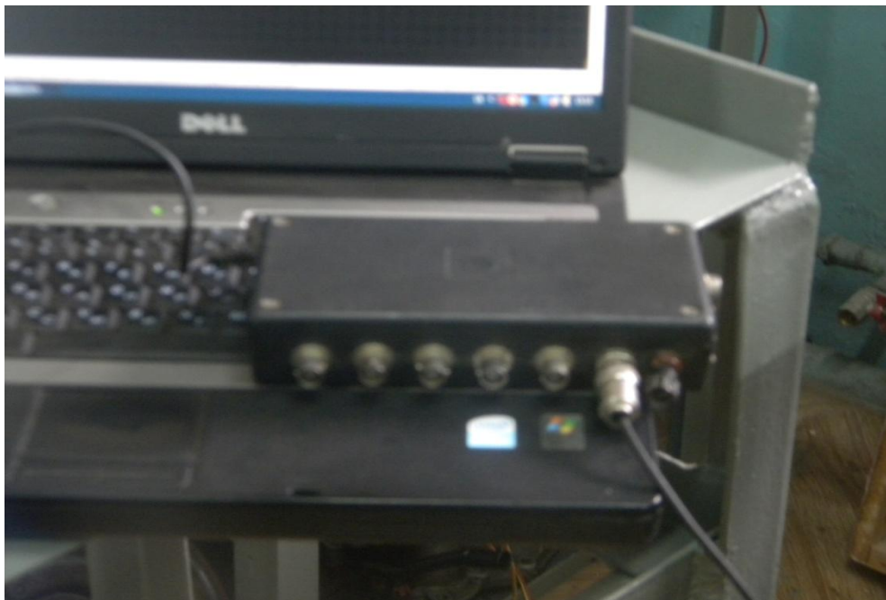
Рисунок 5.6 – Мотор-тестер для діагностики датчиків та виконавчих механізмів системи клімат-контролю автомобіля
