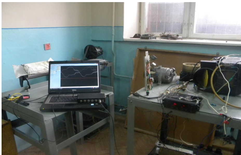
Рисунок 5.10 – Підключення мотор-тестера для зняття осцилограми датчиків системи клімат-контролю
