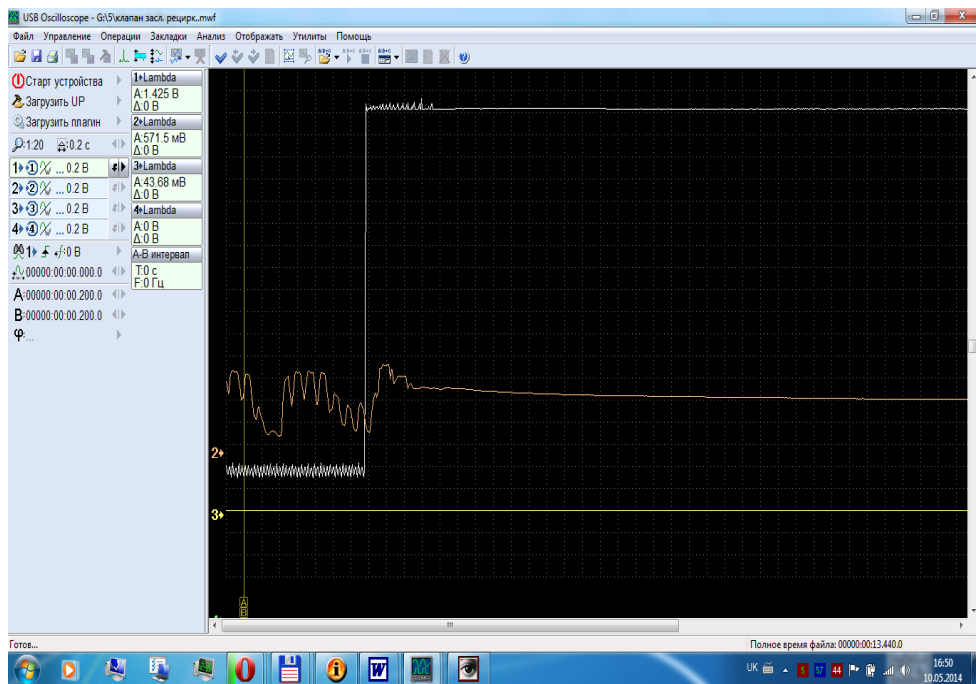
Рисунок 5.16 - Осцилограма вхідного сигналу вакуумного клапану заслінки рециркуляції
