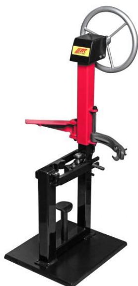
Рисунок 3.9. Стенд для стиснення стійок
