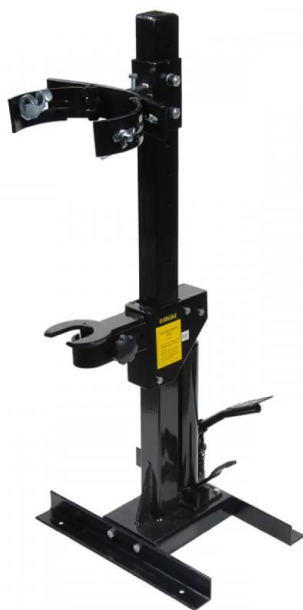
Рисунок 3.8. Стенд для зняття та установки пружин гідравлічний SIGMA
