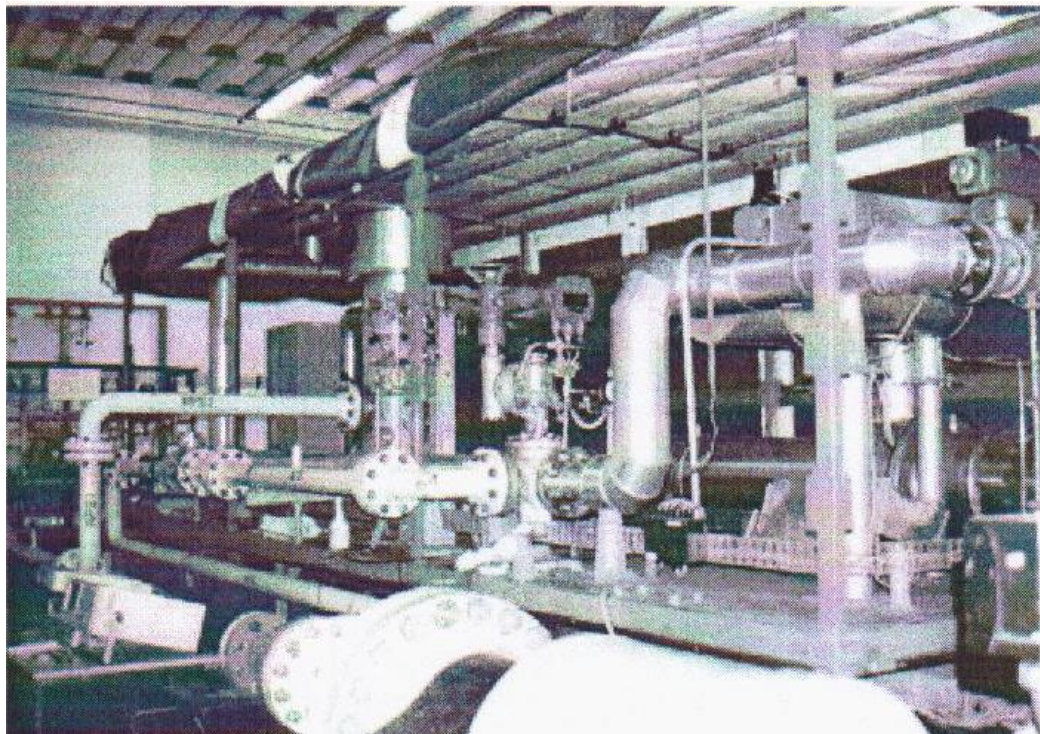
Рисунок 1.2 – Еталонна секція: поршнева установка та трансферний еталонний лічильник
