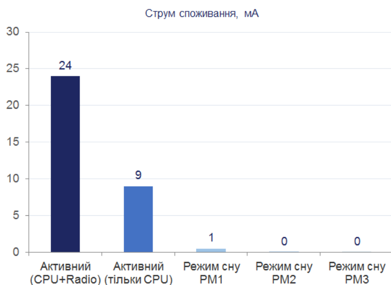
Рисунок 2.3 - Режими енергоспоживання мікроконтролера CC2541
