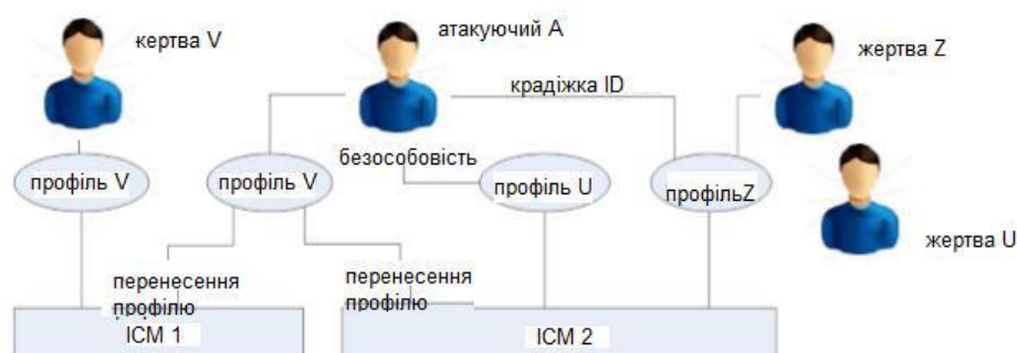
Рис. 3.4. Атаки підробленого вступу: жертва U не має жодного облікового запису ІСМ, жертва V має обліковий запис на ІСМ1, а жертва Z – на ІСМ2.
