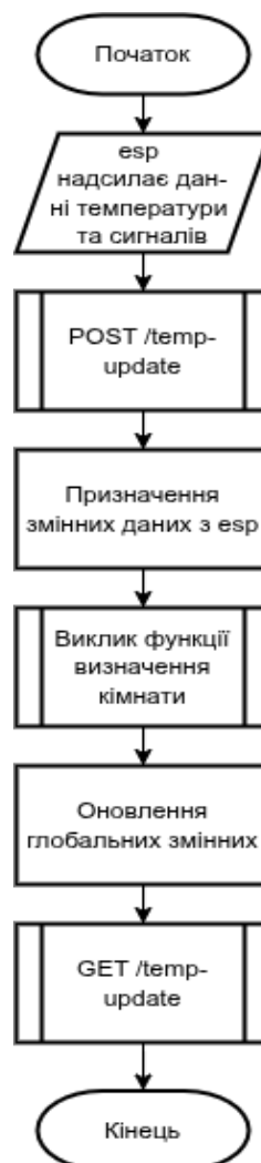
Рисунок 2.9 — Блок схема алгоритму роботи програми
