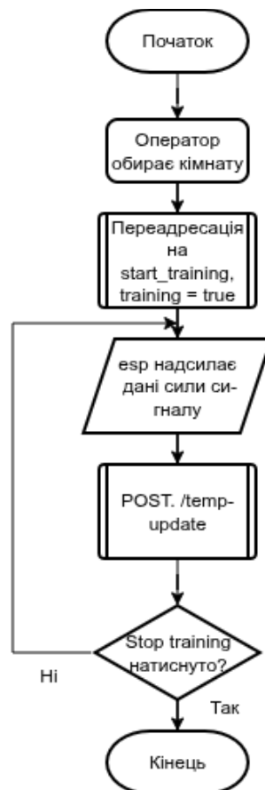
Рисунок 2.8 - Блок схема алгоритму запам'ятовування кімнати
