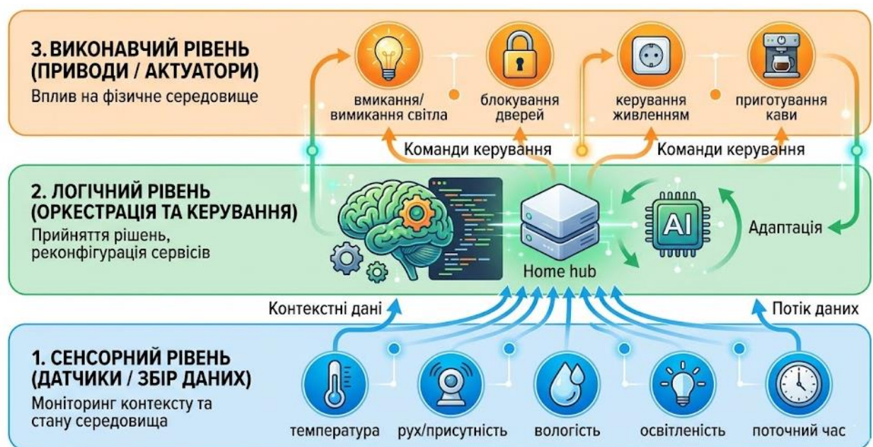
Рисунок 2.5 – Архітектура екосистеми розумного будинку у вигляді атомарних сервісів
