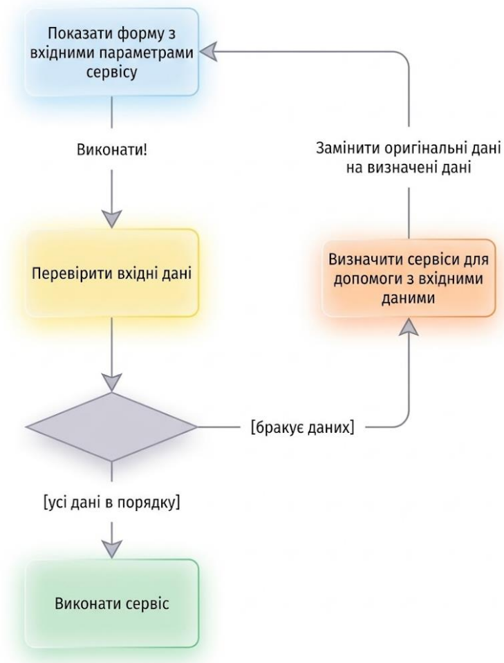
Рисунок 3.3 - Модель повної композиції з відкладеним виконанням ланцюжка
