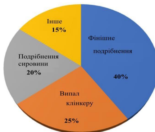
Рисунок 1.1 – Структура споживання енергії устаткуванням цементного виробництва
