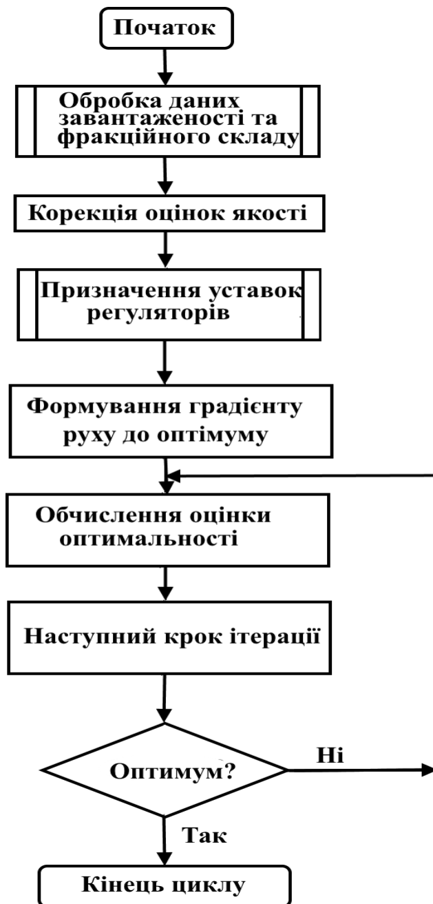
Рисунок 4.5 – Схема алгоритму керування дозуванням
