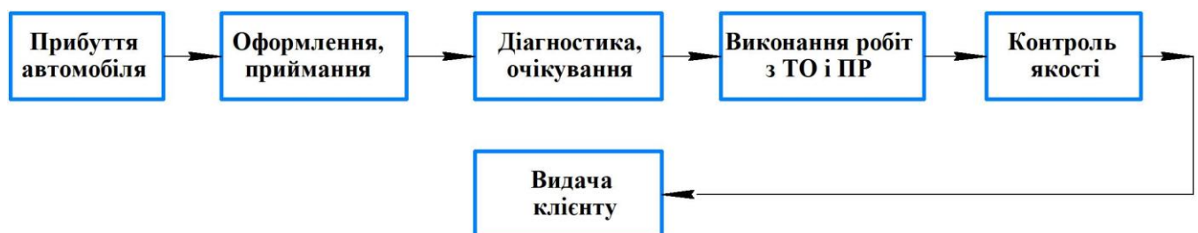
Рисунок 1.1 – Чинна технологічна схема руху автомобіля на СТО «STARMERC»
