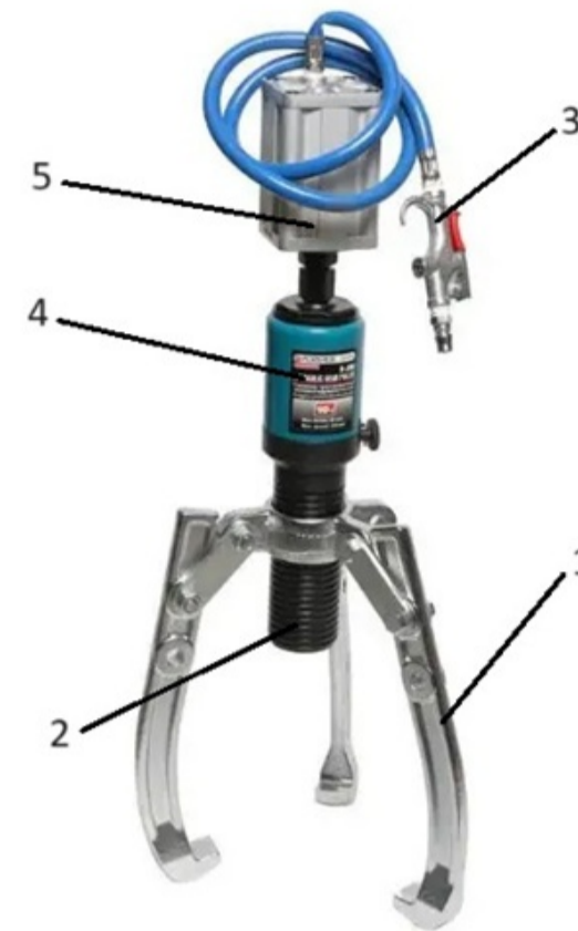
1 – захвати; 2 – гвинт; 3 – пістолет для підведення повітря; 4 – гідроциліндр; 5 – пневмоциліндр
