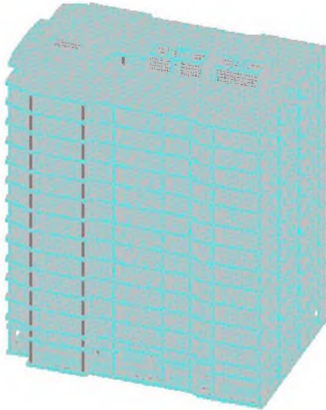
Рис.4.3.2 Розрахункова схема будівлі (кількість вузлів – 95260, кількість елементів – 94790)
