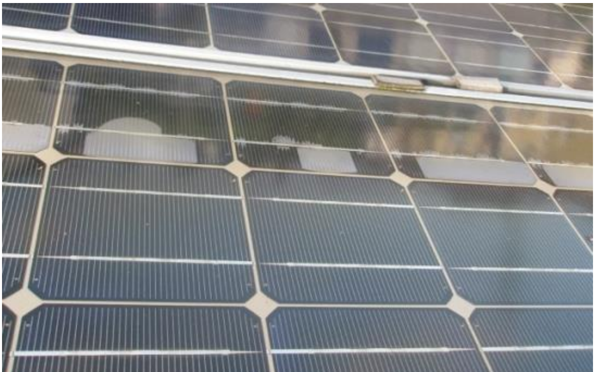
Рисунок 1.5. У плоских помутніннях під переднім склом можна помітити розшарування, які виглядають як бульбашки повітря. [21]
