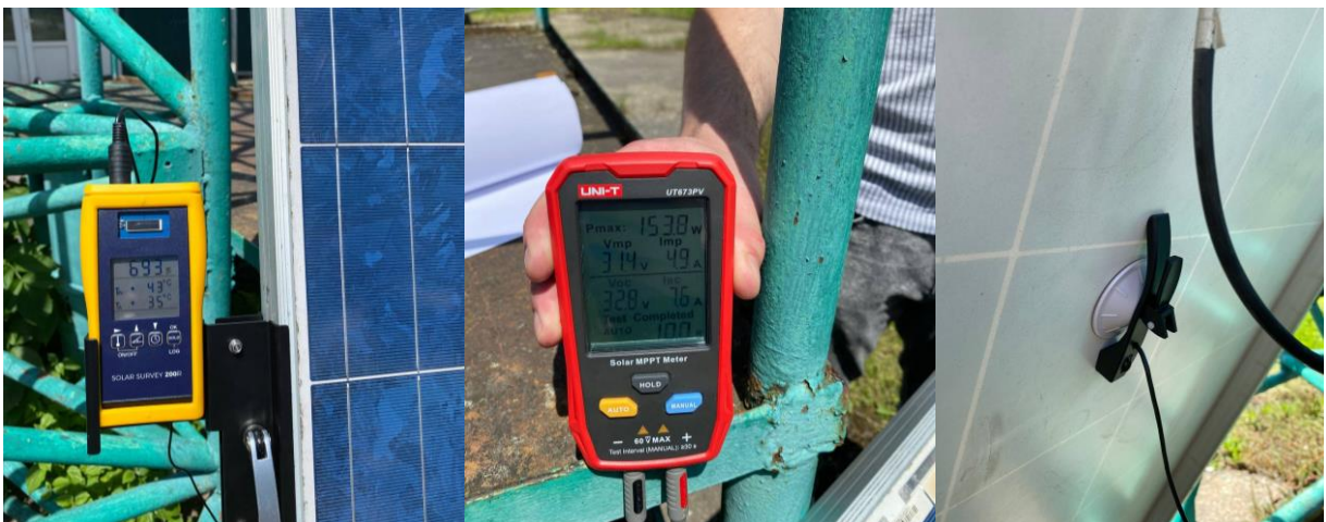
Рисунок 3.3. Використання вимірювальних приладів під час експрес-контролю панелі-свідка. Цифровий тестер UNI-T UT673PV (посередині) [26] , вимірювач інтенсивності сонячного випромінювання Solar Survey 200R (зліва) [27] та датчик температури поверхні сонячної панелі (справа).
