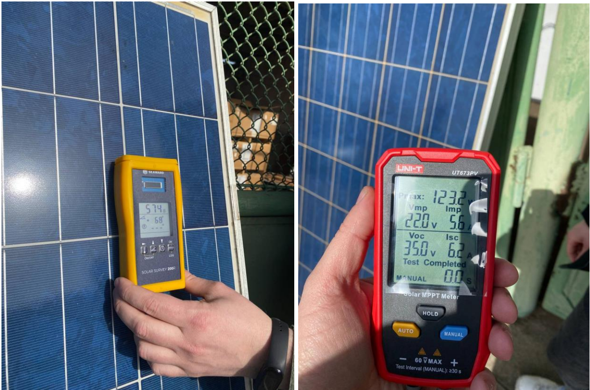
Рисунок 3.2. Використання вимірювальних приладів під час експрес-контролю сонячних панелей. Цифровий тестер UNI-T UT673PV (справа) [26] та вимірювач інтенсивності сонячного випромінювання Solar Survey 200R (зліва) [27].
