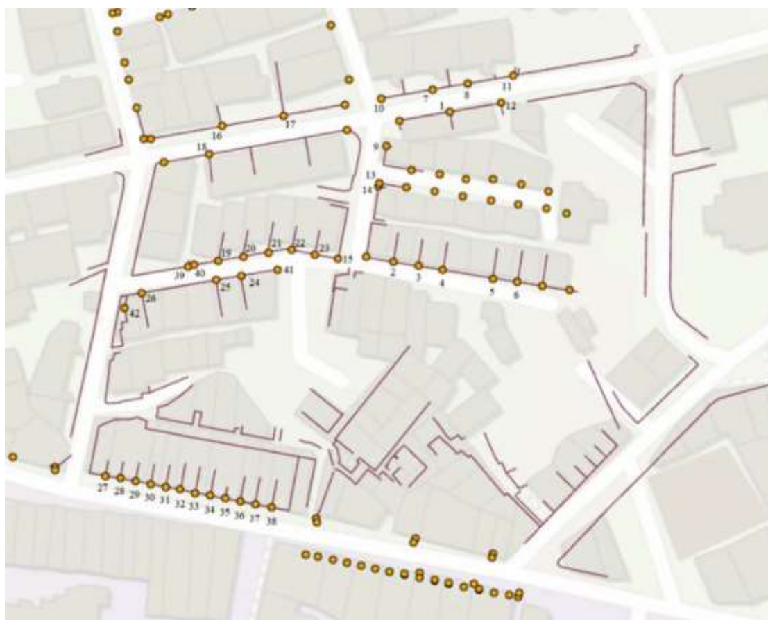
Рисунок 24. Оцифровані результати скоригованих точок, отриманих за допомогою ручного лідарного сканування, та детальні точки, зафіксовані тахеометром, наведено для порівняння
