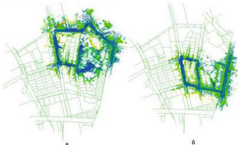
Рисунок 17. Хмара точок після застосування фільтрації. (а) Хмара точок, отримана після фільтрації для сканованого шляху 1. (б) Хмара точок, отримана після фільтрації для сканованого шляху 2.
