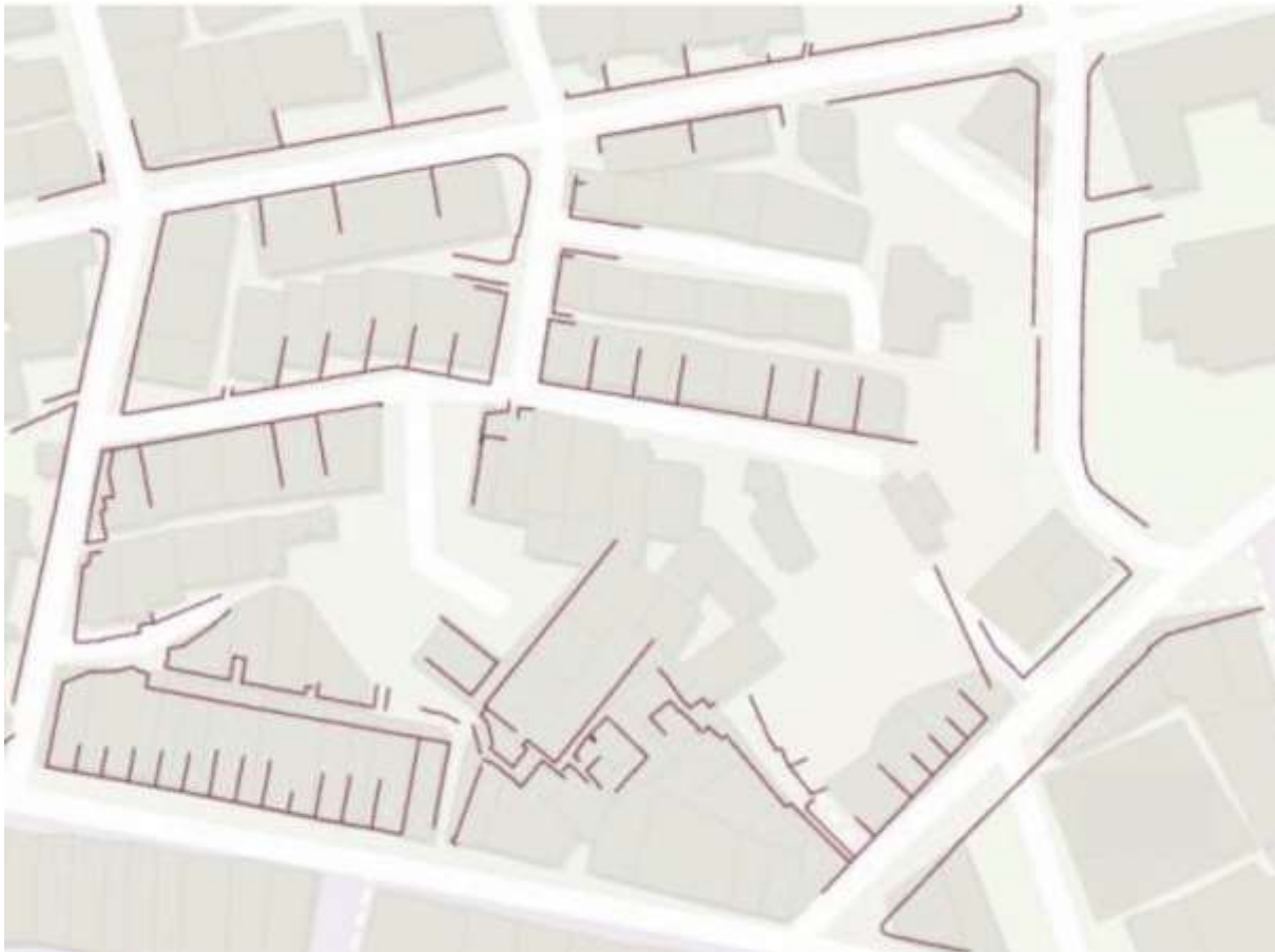
Рисунок 23. Результат оцифрування детальних ліній, виконаного на основі скоригованої хмари точок, отриманої за допомогою ручного сканування.
