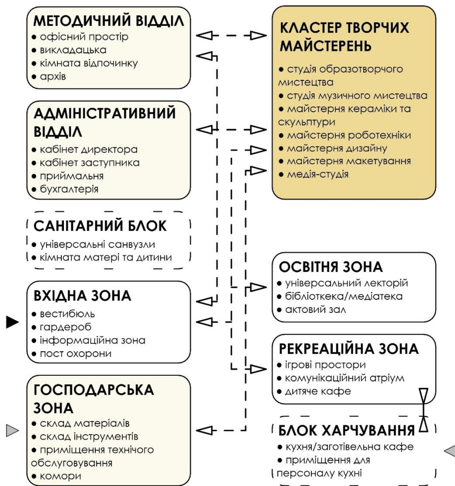
Рис. 1.2.1. Структурно-технологічна схема організації приміщень та кластерів комплексного Центру дитячої творчості
