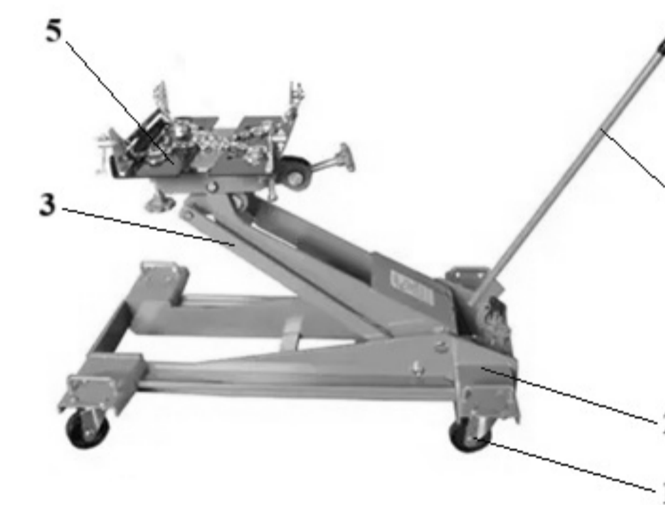
1 – поворотні колеса; 2 – платформа; 3 – рухома стійка; 4 – ручка приводу насосу; 5 – супорт для агрегатів плаваючого типу з фіксацією
