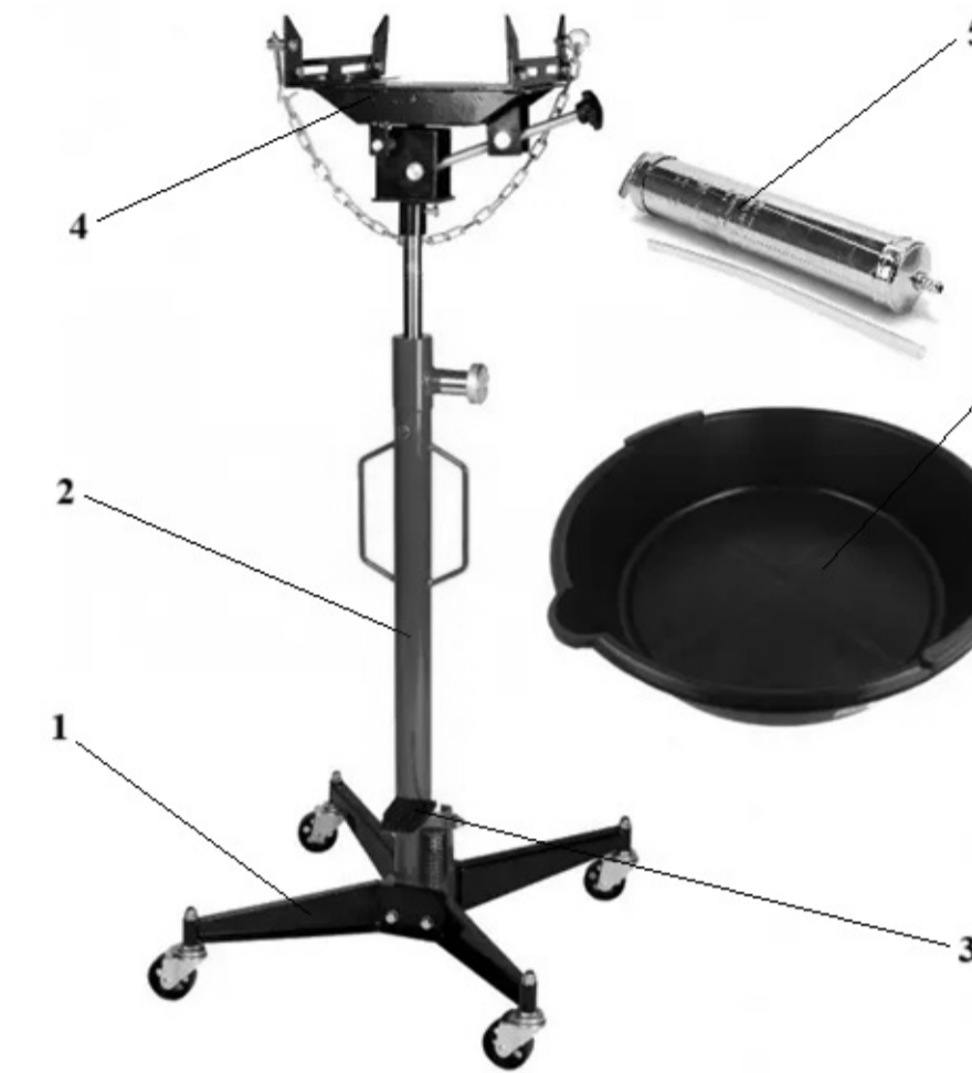
1 – поворотні важелі; 2 – стійка; 3 – педаль приводу; 4 – платформа для агрегатів; 5 – шприц для відбору оливи; 6 – карито для відпрацьованої оливи
