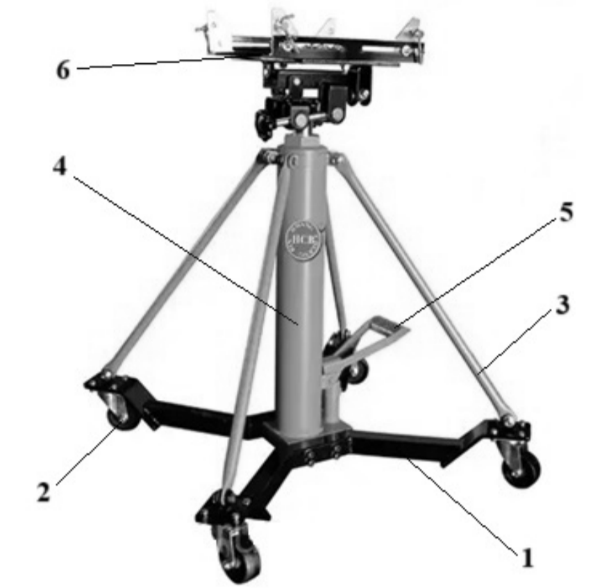
1 – основа; 2 – поворотні колеса; 3 – додаткові опори; 4 – стійка; 5 – педаль керування; 6 – супорт для агрегатів плаваючого типу з фіксацією
