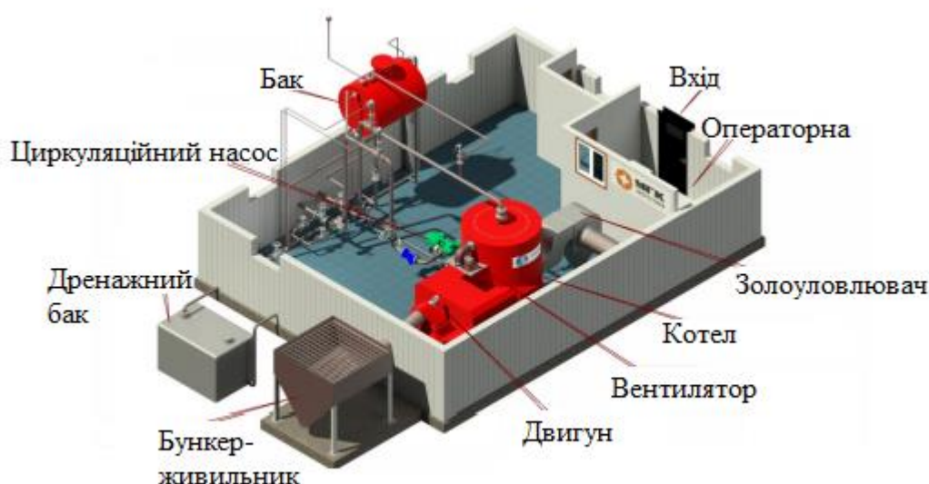
Рис. 1.1 – Загальний вигляд термомасляної котельні
