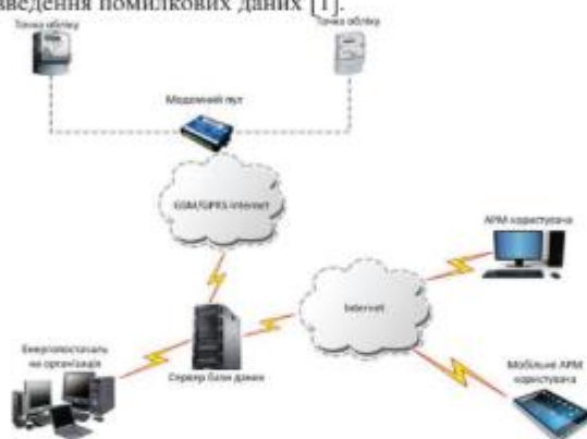
Рисунок 1 - Автоматизована система комерційного обліку електроенергії
