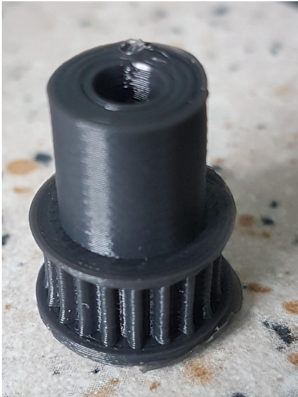
Рисунок 6 - Шестерня, надрукована на 3D принтері
