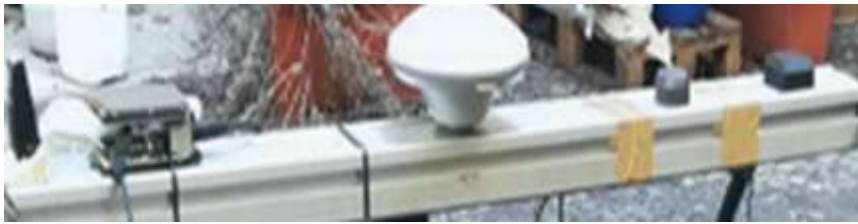
Рис. 2. GNSS-приймачі, антена, джерело живлення і лептоп, розміщені на платформі
