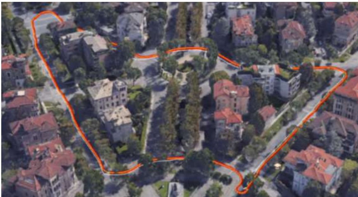
Рис. 3. Дані RTK з усіх 3 GNSS приймачів, накладені на Google Earth
