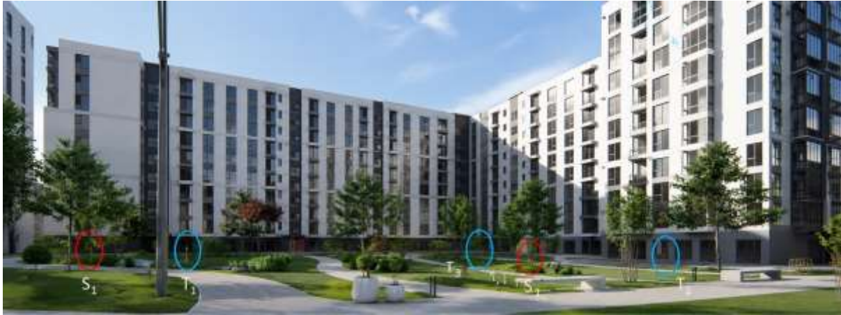
Рисунок 10. Панорамний вигляд польових випробувань Червоні кола = станції сканування, сині кола = положення цілей
