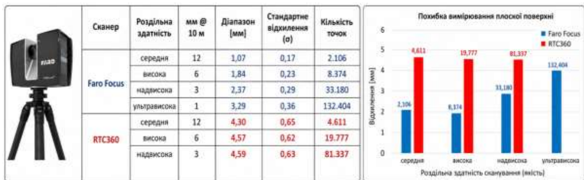
Рисунок 8 Результати похибки вимірювання площинності
