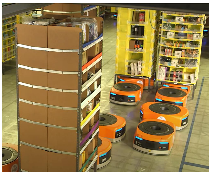
Рис 1.2. Перевезення полиць із товаром роботами.
