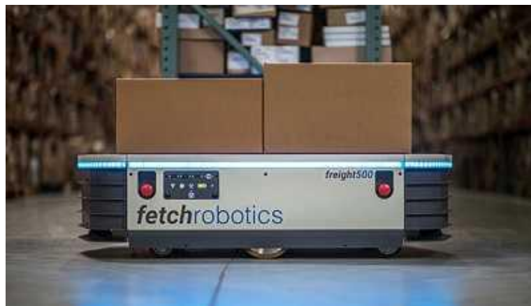
Рис. 1.17 Роботи Freight для переміщення великих вантажів
