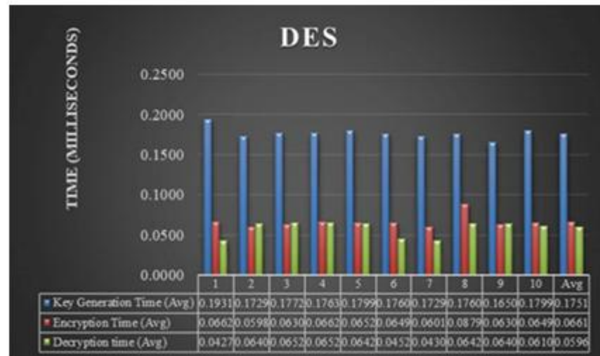
Рисунок 3.12 - Графік середнього часу виконання DES для 10 експериментів
