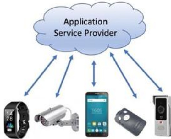
Рисунок 1.4 Пряма модель зв'язку (Device-to-Cloud).
