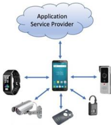
Рисунок 1.6 Транзитна модель зв'язку (Device-to-Gateway).
