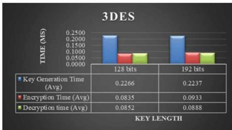
Рисунок 3.13 - Графік середнього часу виконання 3DES для 10 експериментів
