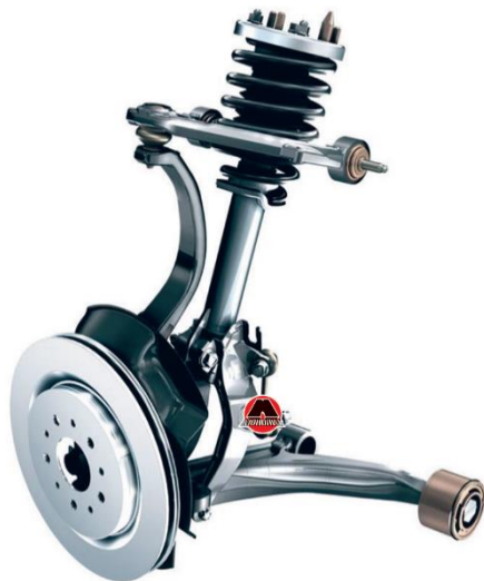
Рис. 5.2 - Схема двоважильної передньої підвіски автомобіля
