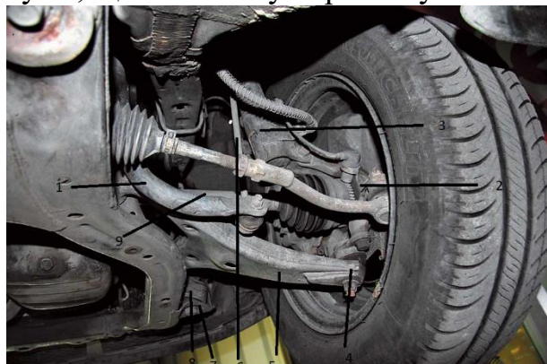
Рис. 5.7 - Передня підвіска автомобіля Hyundai Accent
