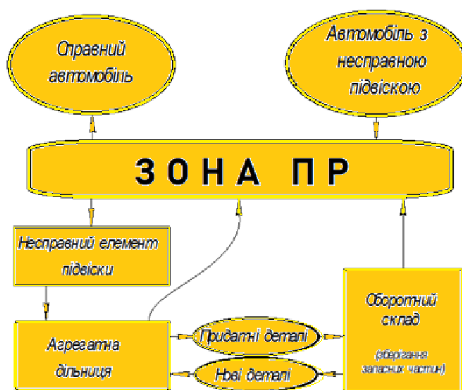
Рис. 6.1- Структурна схема процесу ремонту підвіски автомобіля Hyundai Accent.
