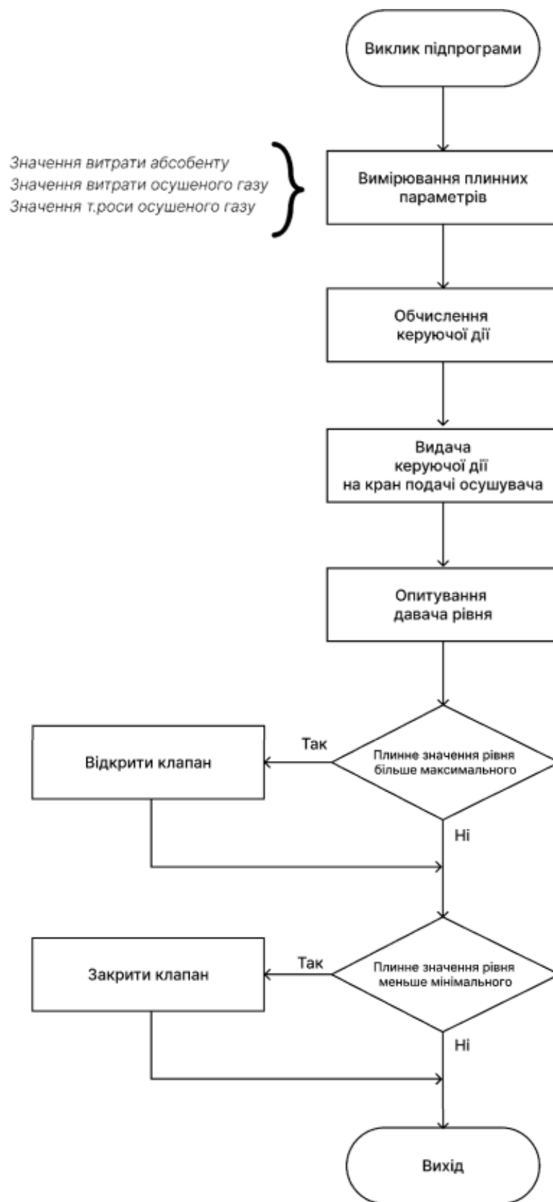
Рисунок 4.3 – Блок-схема логіки функціонування підпрограми керування абсорбцією
