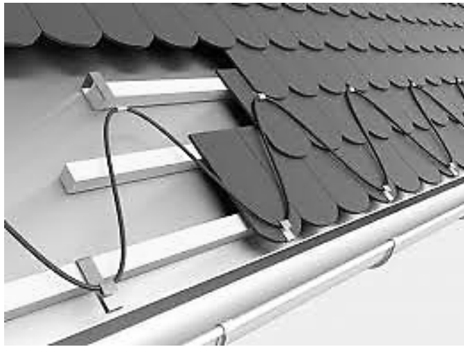
Рис. 10.16. Загальний вигляд системи електрокабельного резисторного сніготанення
