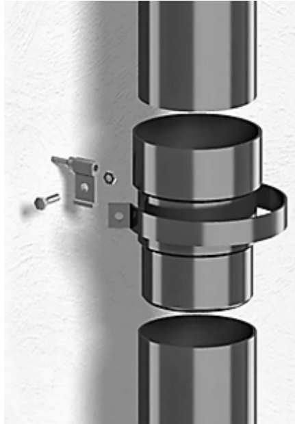
Рис.10.10 Схема з'єднання водостічних труб муфтою
