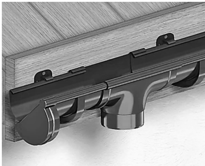
Рис. 10.5. Схема встановлення водостічних лійок та кронштейнів (хомутів або гаків)
