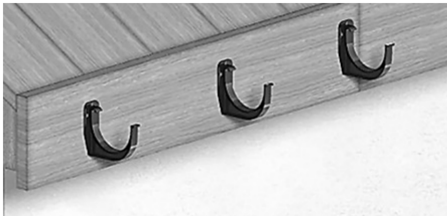
Рис. 10.7. Схема встановлення кронштейнів ринви (гаків)
