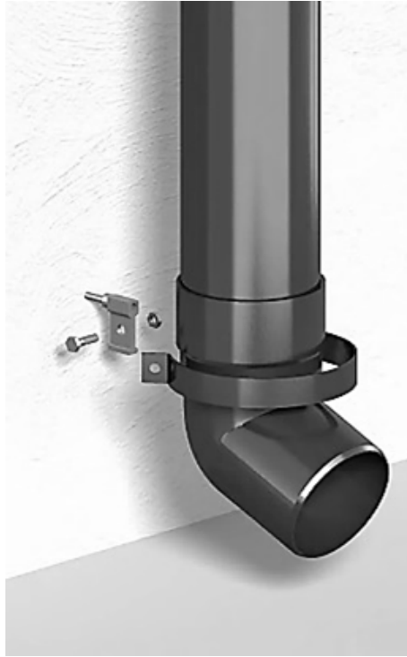
Рис. 10.11. Схема встановлення хомута для кріплення водостічної труби
