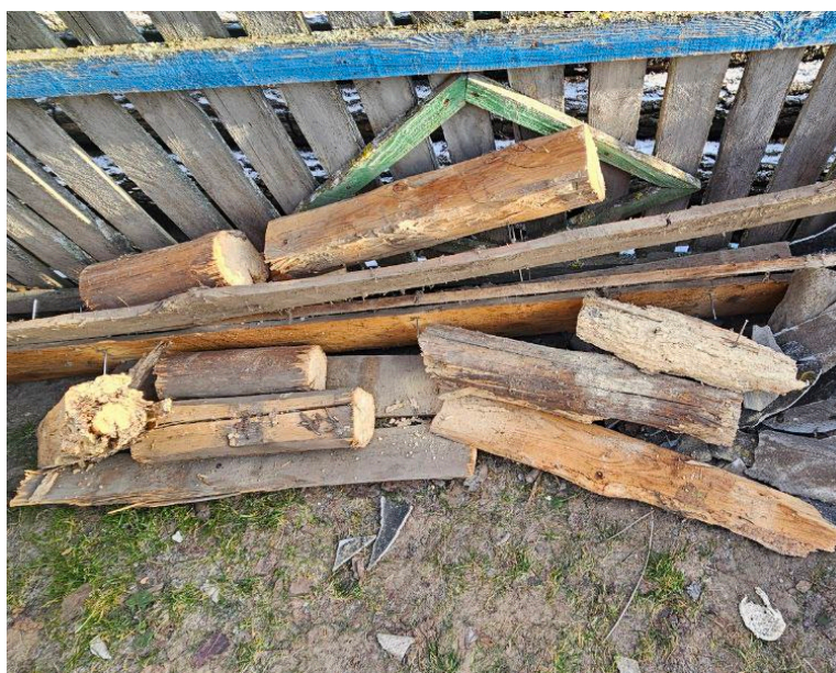
Рис. 12.2. Залишки гнилої стропильної ноги, пошкодженої внаслідок дії води як фактору вторинного руйнування.
