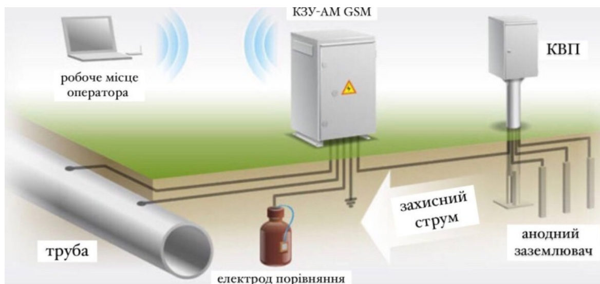
Рисунок 1.7 – Катодний захист
