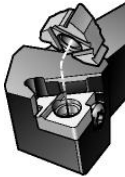
Рис. 1.15. Встановлення робочої різальної пластини на підкладну пластину
