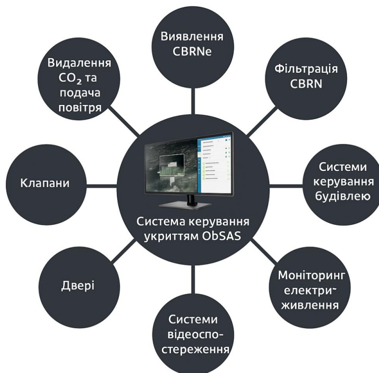
Рисунок 1.7 – Структурна схема взаємодії компонентів системи ObSAS
