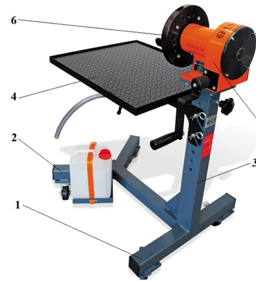
1 – основа стенду; 2 – поворотне колесо; 3 – стійка; 4 – платформа для зливу оливи; 5 – черв'ячний редуктор з ручним приводом; 6 – платформа для встановлення двигуна
