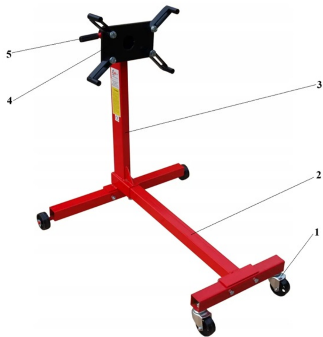
1 – поворотне колесо; 2 – основа стенду; 3 – стійка; 4 – платформа для встановлення двигуна; 5 – черв'ячний редуктор
