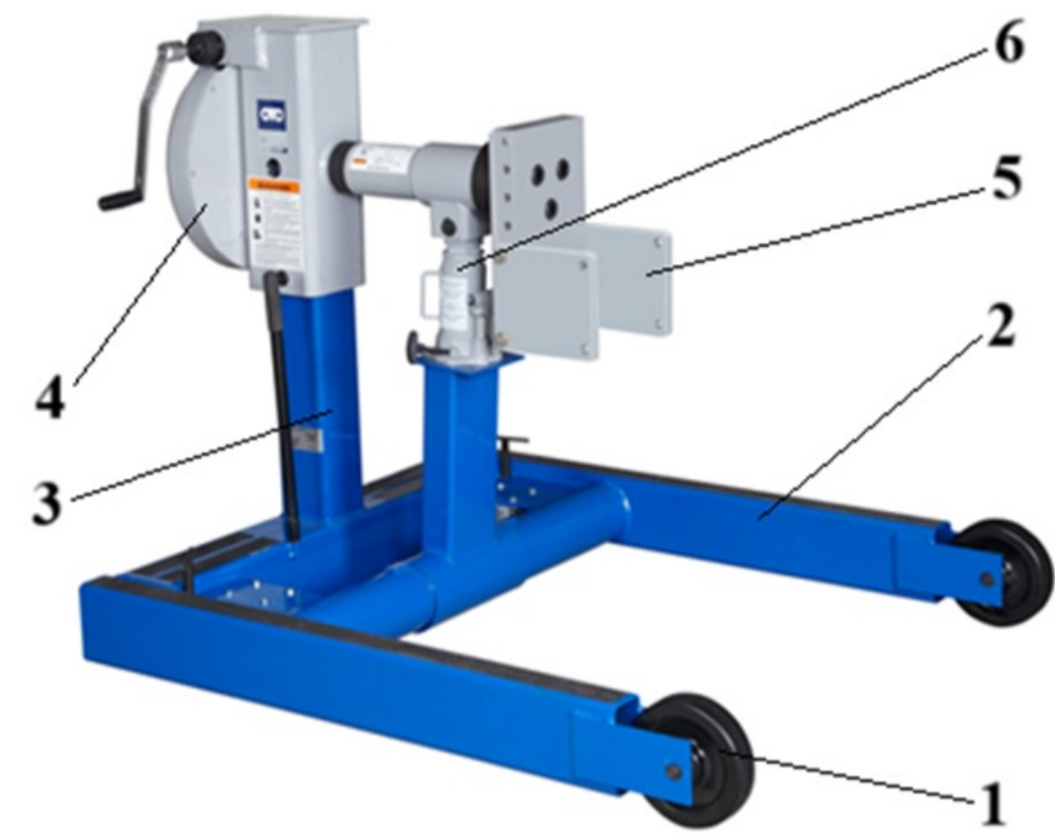
1 – колесо; 2 – основа стенду; 3 – стійка; 4 – черв'ячний редуктор; 5 – платформа для встановлення двигуна; 6 – домкрат
