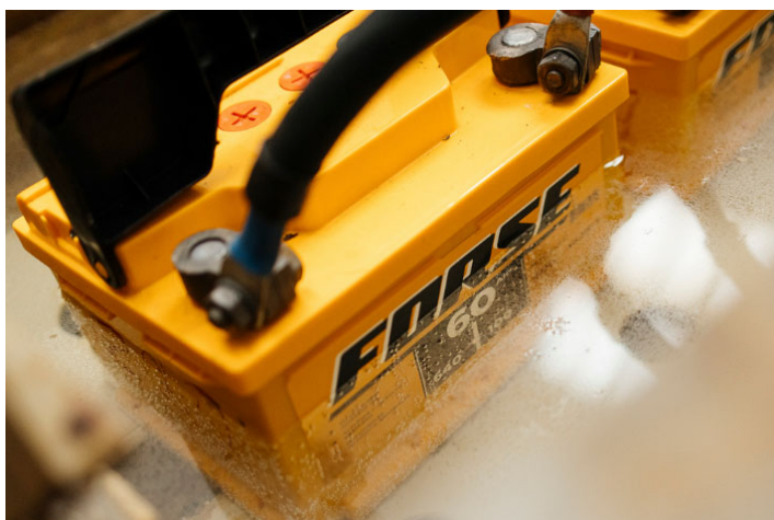
Рисунок 2.1 – Тестування АКБ у температурній ванні
