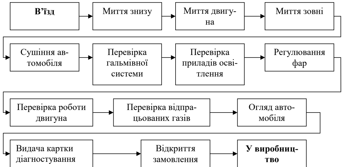
Рисунок 5.1 - Схема поточного технологічного процесу приймання автомобіля на ТО та ремонт СТО «Мерседес»
