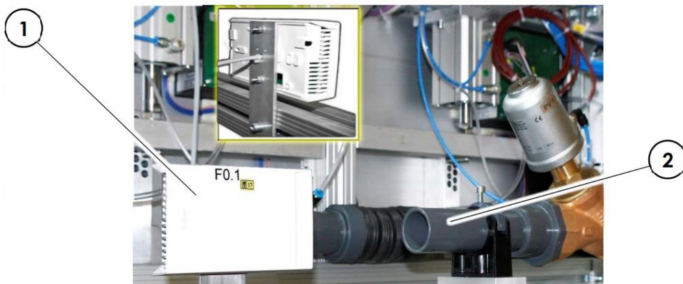
Рисунок 3.6 – Давач вологості на всмоктувальних патрубках
