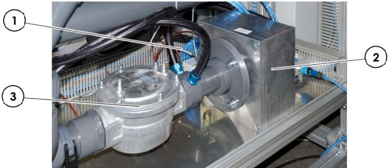
Рисунок 3.7 – Технологічний блок з 7 сопел
