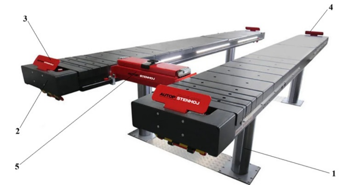
1 – плунжер; 2 – платформа; 3 – упорна планка; 4 – заїзний мостик; 5 – додатковий підіймач
