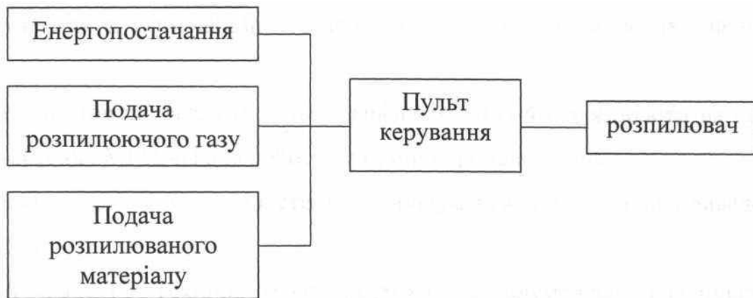
Рис.3.2 – Функціональна схема установки для газотермічного напилення
