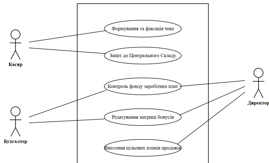
Рисунок 4.4. - UML-діаграма прецедентів взаємодії користувачів із сервісним рівнем
