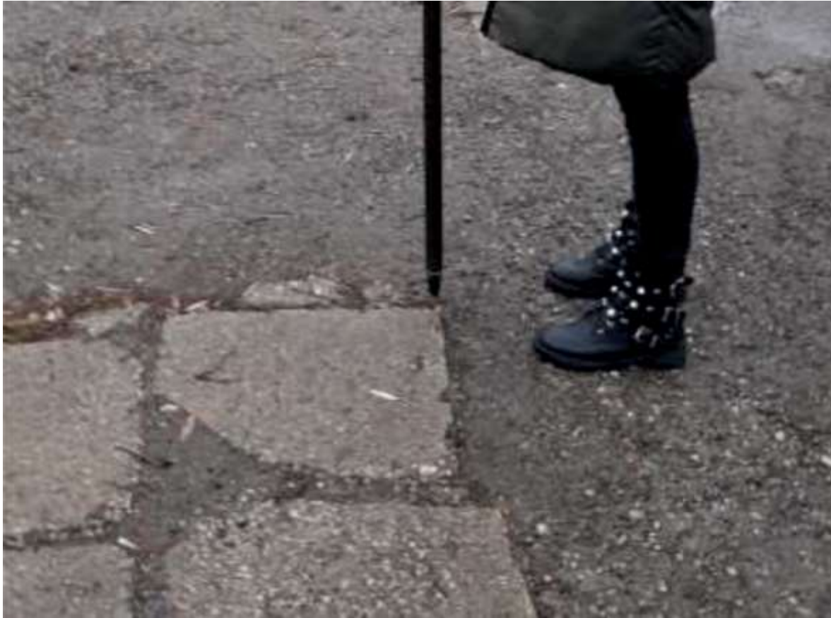
Рисунок 5 Наземні контрольні точки на характерних довгострокових елементах місцевості
