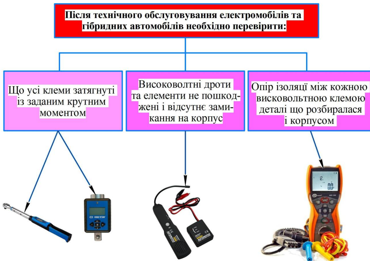
Рисунок 4.7 – Дії після технічного обслуговування електромобілів та гібридних автомобілів
