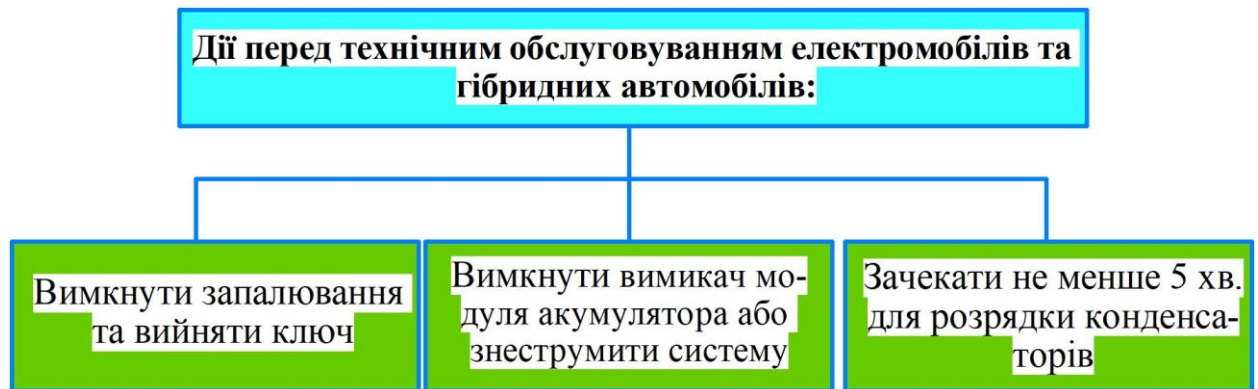
Рисунок 4.4 – Операції що виконуються перед технічним обслуговуванням електромобілів та гібридних автомобілів
