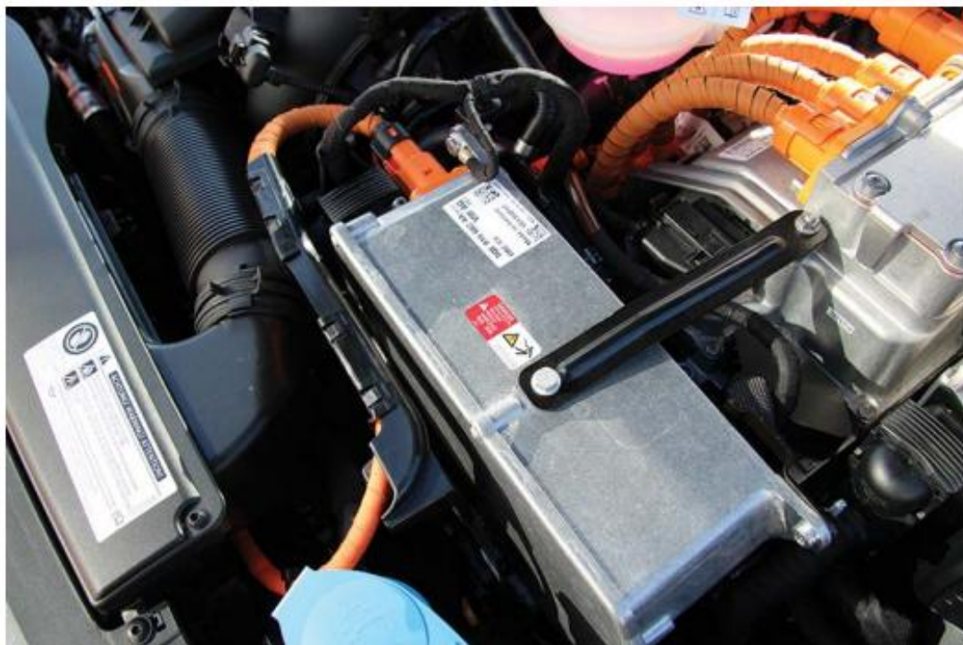
Рисунок 4.10 – Помаранчеві високовольтні кабелі
