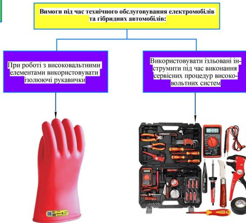
Рисунок 7 – Використання захисних пристроїв під час технічного обслуговування електромобілів та гібридних автомобілів
