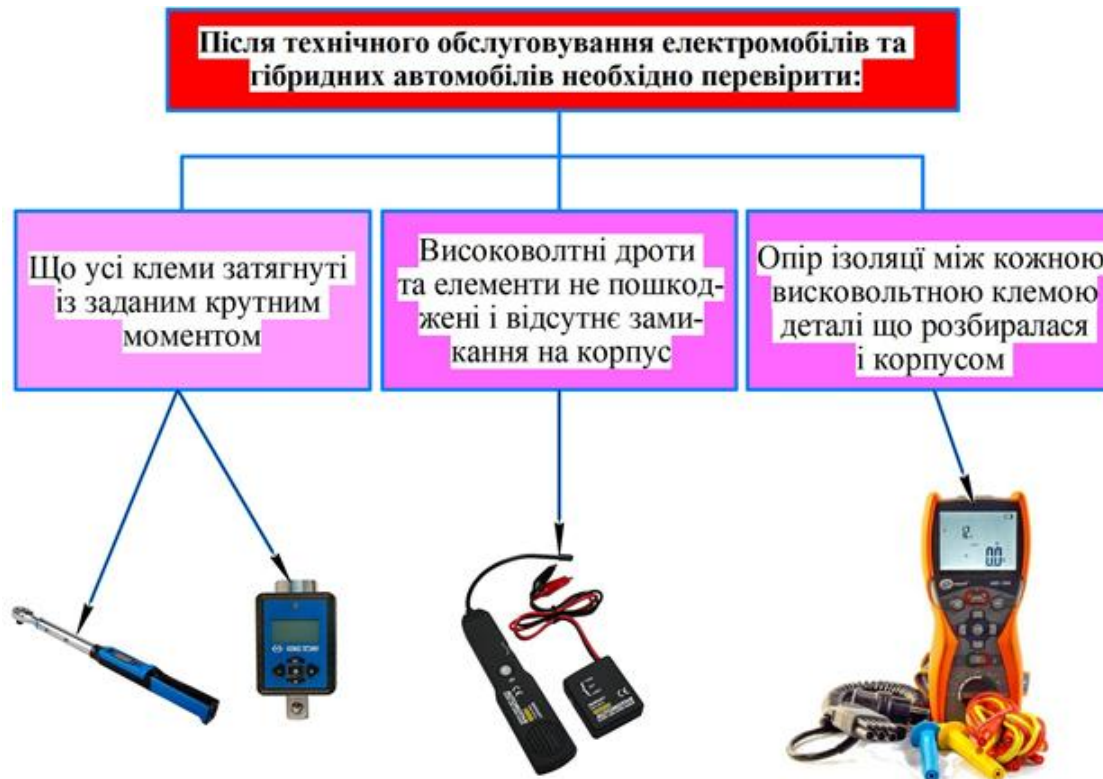
Рисунок 9 – Дії після технічного обслуговування електромобілів та гібридних автомобілів
