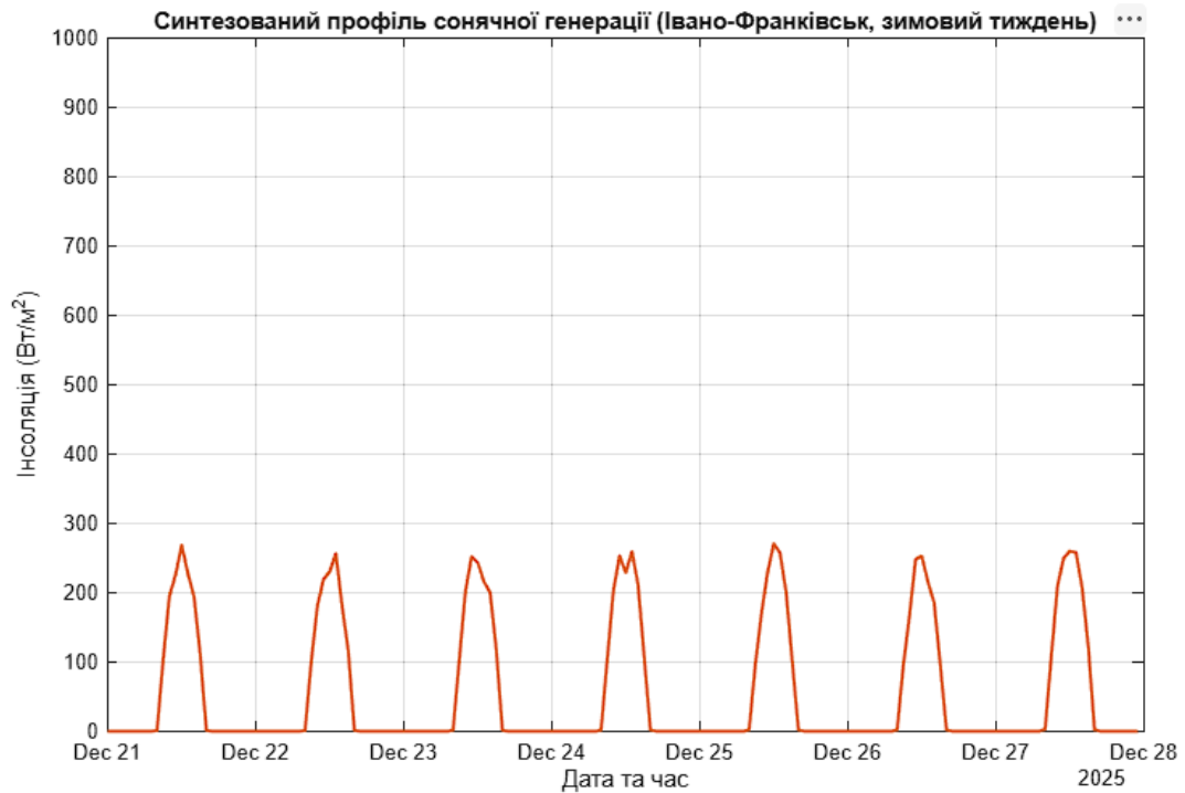
Рисунок 3.3 – Результат моделювання профілю сонячної генерації у м. Івано-Франківську (зимовий тиждень)
